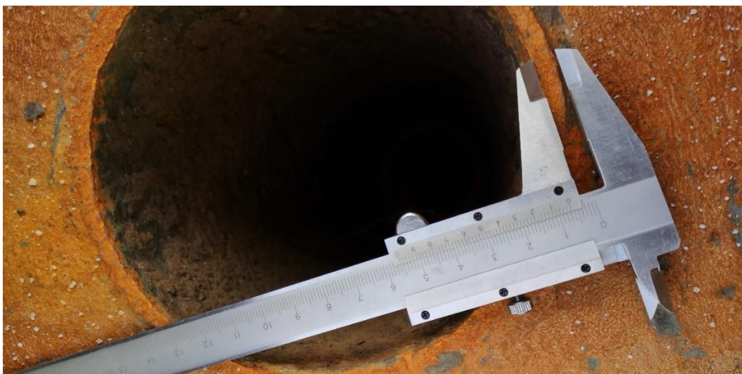
Prostup pro svod – původní tloušťka vevařené trubky (6 mm)
