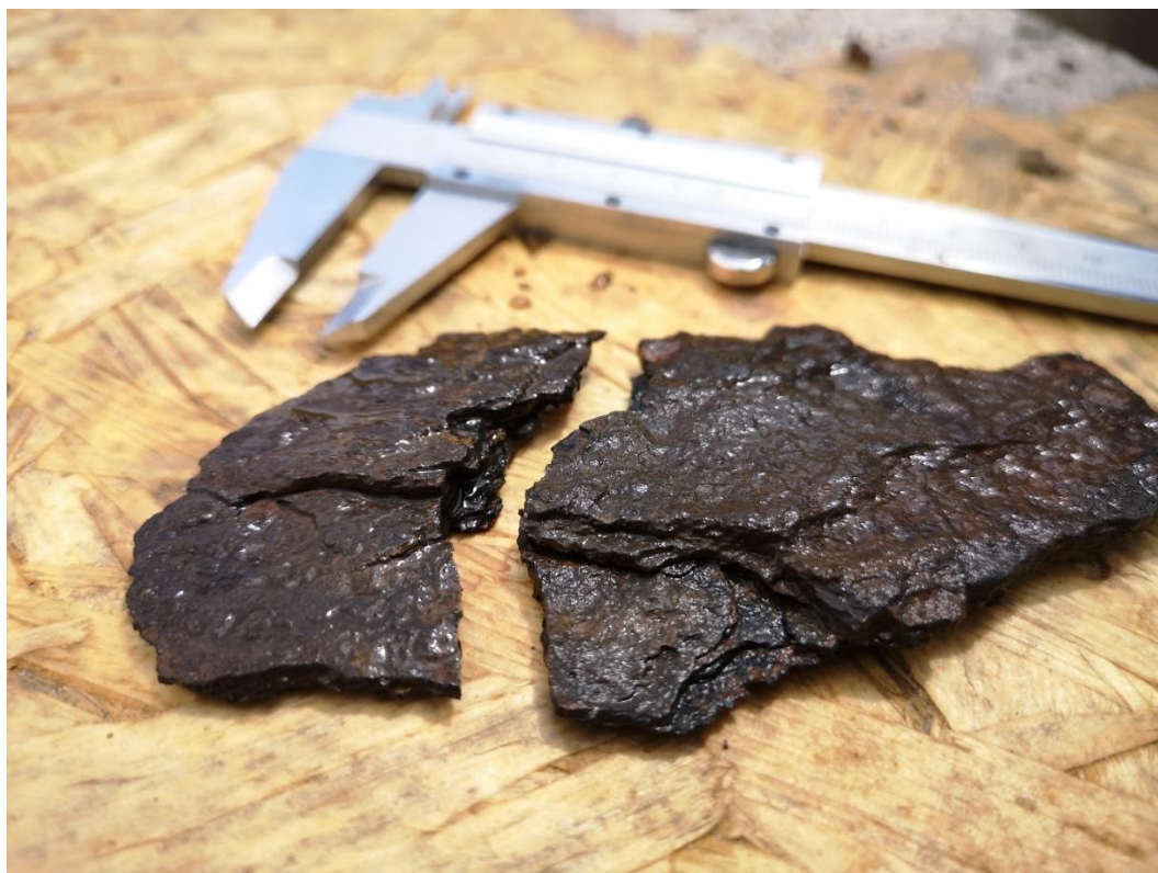
Korozní produkt z horní pásnice páteřního nosníku
