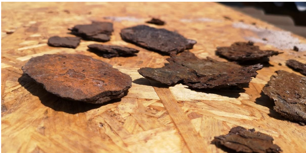
Korozní produkt z horní pásnice páteřního nosníku a prostupu pro svod
